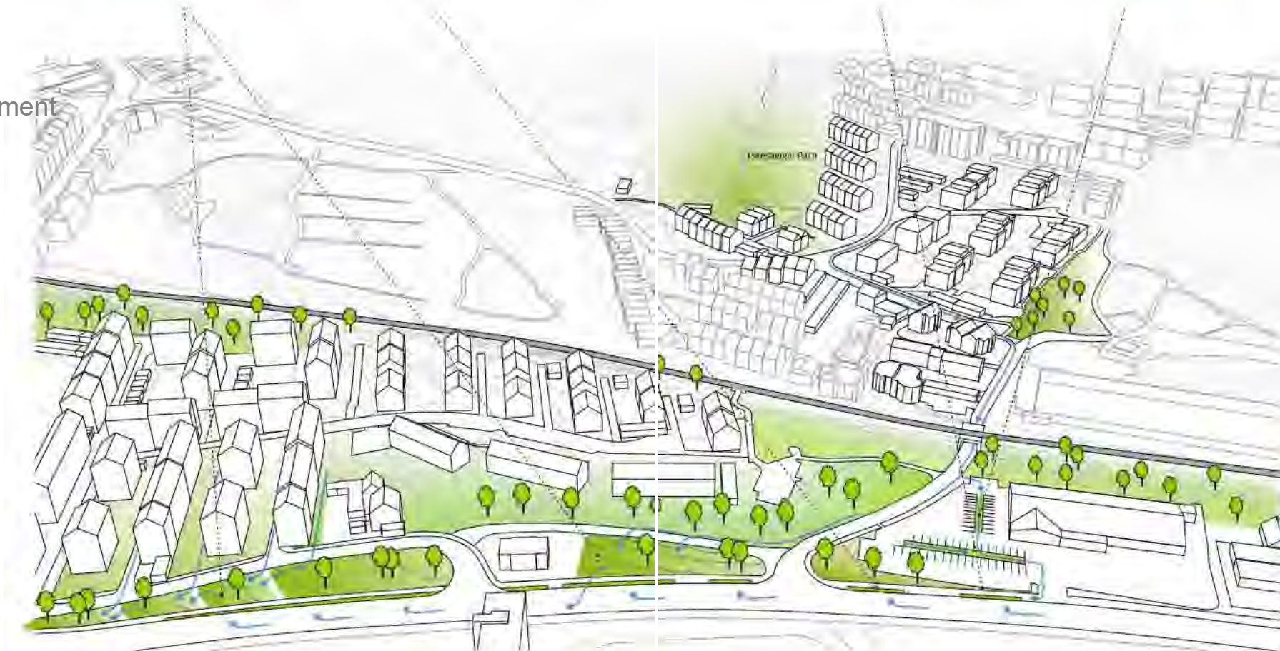
Abb. 120 Durch die Abfolge von Maßnahmen in Fließrichtung entlang der Otto-Hausmann-Straße wird das Überflutungsrisiko in den Teilbereichen gesenkt und verbessert die Akkumulation von Regenwasser für die sonst unter liegenden Gebiete (ILPÖ 2015)
