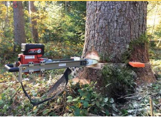
5 Mechanischer Fällkeil im Schnabelschnitt
