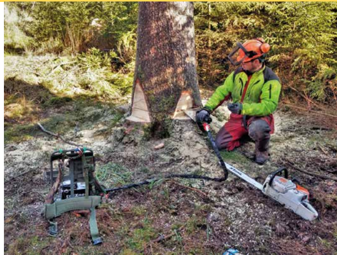
6 Fernbedienbarer hydraulischer Fällkeil
