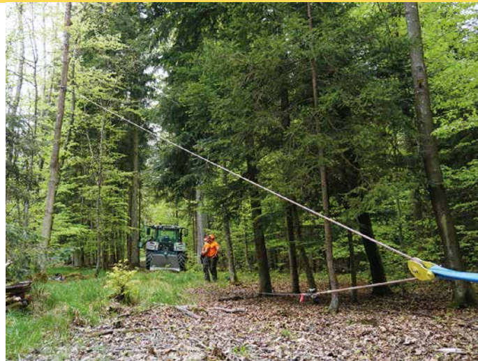
3 Seilwindenunterstützte Fällung: Beim »umgelenkten Zug« wird der Baum vom Schlepper weggezogen. Foto: Bayerische Waldbauerschule
